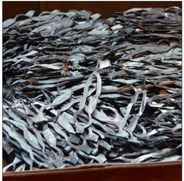
Recycling war schon immer ein großes Thema in der Solinger Industrie. Solche Stanz-„Abfälle“ wurden natürlich wieder eingeschmolzen und erneute zu Blech gewalzt.
